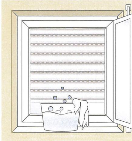
Wir empfehlen Kunststoffreiniger für Hart-PVC. Bitte verwenden Sie keine lösungsmittelhaltigen oder körnigen Reiniger. Wichtig ist die Nachbehandlung mit einem Antistatikum.
