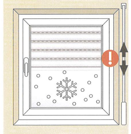
An kalten und frostigen Tagen könnte Ihr Rollladen anfrieren. Bitte wenden Sie in diesem Fall keine Gewalt an. Lassen sie spezielle motorbediente Rollladen nicht unbeaufsichtigt laufen, und stoppen Sie sofort falls der Rollladen angefroren ist. Schalten Sie ggf. automatische Steuerungen und Zeitschaltuhren im Winter zusätzlich auf Handbedienung.
