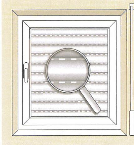
An sonnigen und heißen Tagen sollten Sie beachten, dass die Licht und Lüftungsschlitze geöffnet bleiben! Sie sorgen so für eine ausreichende Hinterlüftung Ihres Rollladens und vermeiden einen Hitzestau, der dazu führen könnte, dass der Rollladen ausbaucht.
