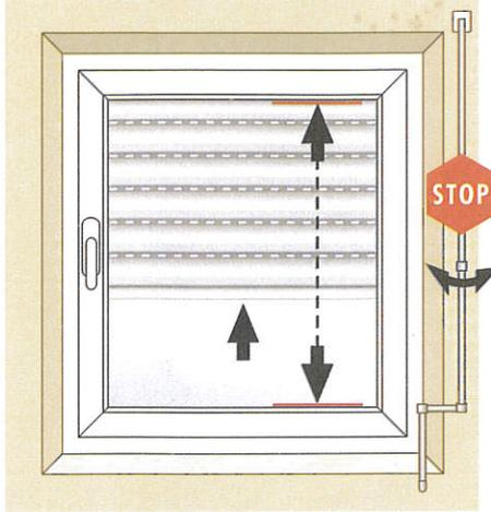
Achten Sie auf die korrekte Drehrichtung der Kurbel! Kurbeln Sie nicht weiter, wenn Ihr Rollladen ganz geöffnet bzw. geschlossen ist. Bei Kurbelantrieb Kurbeln am Gelenk nicht zu stark ablenken, max. 30°
